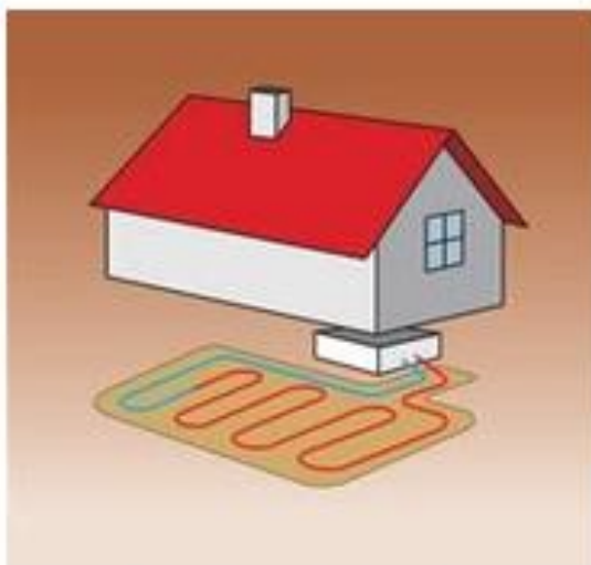
Tepelné čerpadlo nemrznoucí kapalina/voda - výměník naplněný nemrznoucí směsí ochlazuje půdu ve vrtu nebo ve výkopu, případně vodu ve vodním toku nebo v rybníku.
