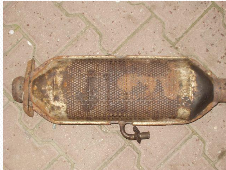
Obr. 23-26: Starý rozebraný dvojitý katalyzátor GM [x]
