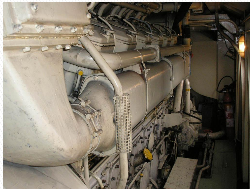
Obr. 26: Spalovací motor je typu ČKD K 12 V 230 DR (až 1 400 kW) [x]
