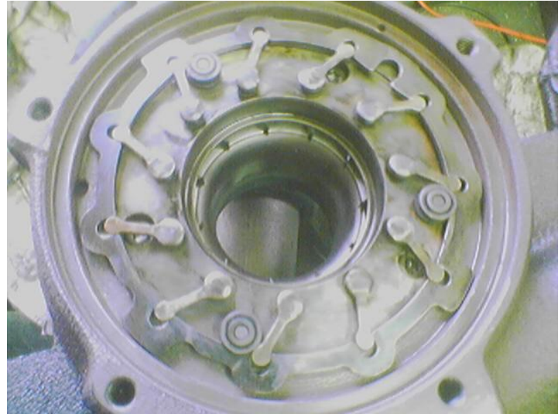
Obr. 18 a 19: Zanesené a čisté turbodmychadlo (čištěno ultrazvukem) [x]
