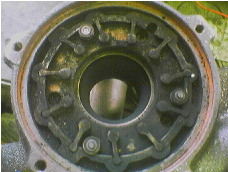
Obr. 18 a 19: Zanesené a čisté turbodmychadlo (čištěno ultrazvukem) [x]
