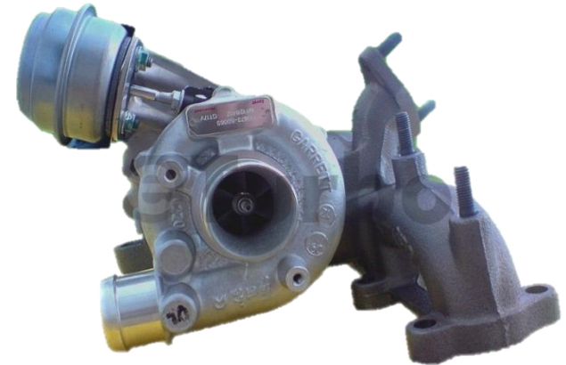
Obr. 13: Turbodmychadlo Garrett z vozu Škoda Octavia I – 1,9 TDI (81 kW) [x]
