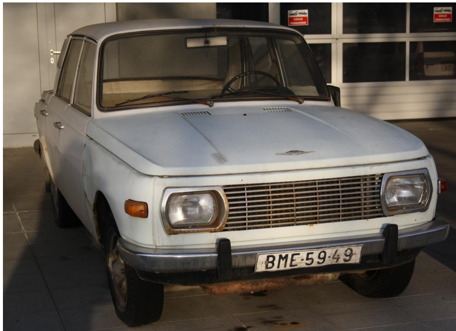
Obr. 14: Wartburg 353 (1965) – populární vozidlo s dvoudobým 3 válcem (992 ccm) [x]
